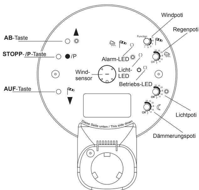
Der Sensero AC ist ein Sonnen-/Dämmerungs- und Windsensor für Sonnenschutzanlagen.
