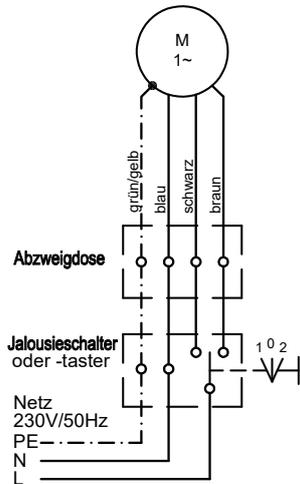
Fig. 4 Schaltbild VariEco L RH 230 V / 50 Hz
