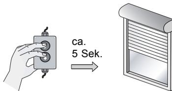
3. Drücken Sie **gleichzeitig** beide Tasten am Montagekabel.
