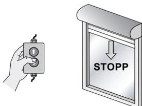
3. Drücken Sie solange die **AB**-Taste, bis der Antrieb automatisch stoppt.
