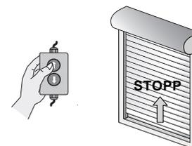
6. Drücken Sie solange die **AUF**-Taste, bis der Antrieb automatisch stoppt.
