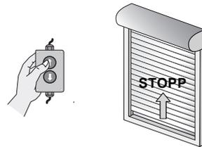
6. Drücken Sie solange die **AUF**-Taste, bis der Antrieb automatisch stoppt.
