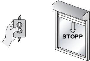
3. Drücken Sie solange die **AB**-Taste, bis der Antrieb automatisch stoppt.
